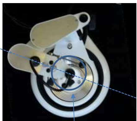
Bewegungsradius der Frässpindel nach Drehung der Frässchale für die Bearbeitung von Teleskop Nr.2
